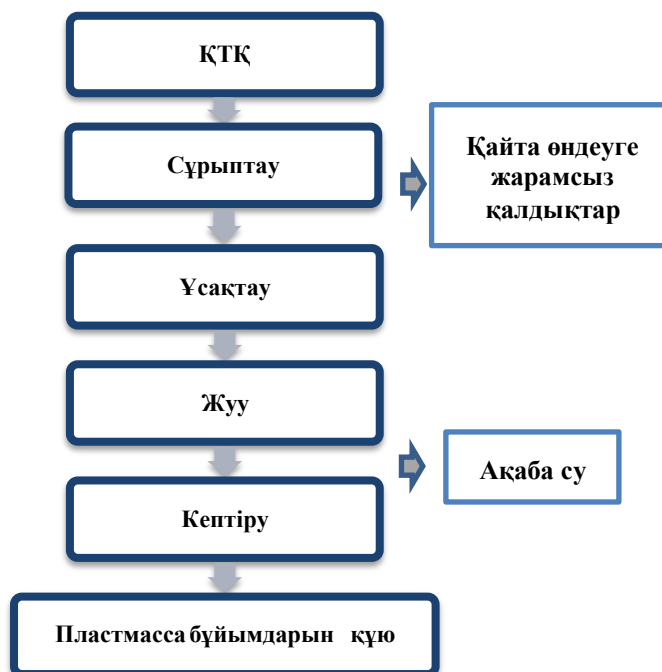
Сурет 15- Пластик қалдықтарын қайта өңдеудің блок-схемасы
